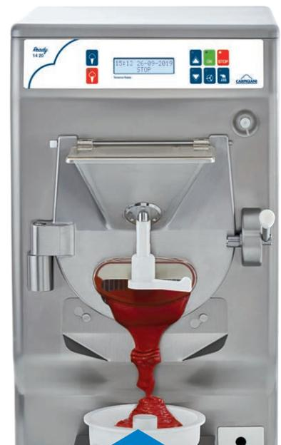
Dank des **Abstandhalters**, der jederzeit angebracht werden kann, ist es möglich, die Eisauslassöffnung zu reduzieren, um die Entnahme des Produktes Crystal und die Reinigung der Maschine zu erleichtern.
