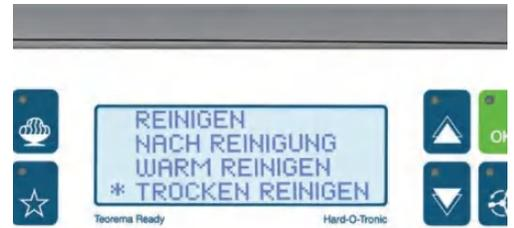
Nach Beendigung der Reinigung können mit dem **Trocknungsprogramm** alle **Feuchtigkeitsrückstände im Zylinder beseitigt werden**, was eine wesentliche Voraussetzung ist bevor man Schokolade temperiert.
